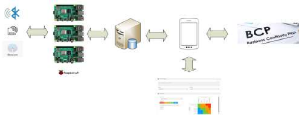
Obrázok 2 Bloková schéma informačného systému Cov-ID určeného na trasovanie osôb a vyhodnotenia rizikovosti možného kontaktu
