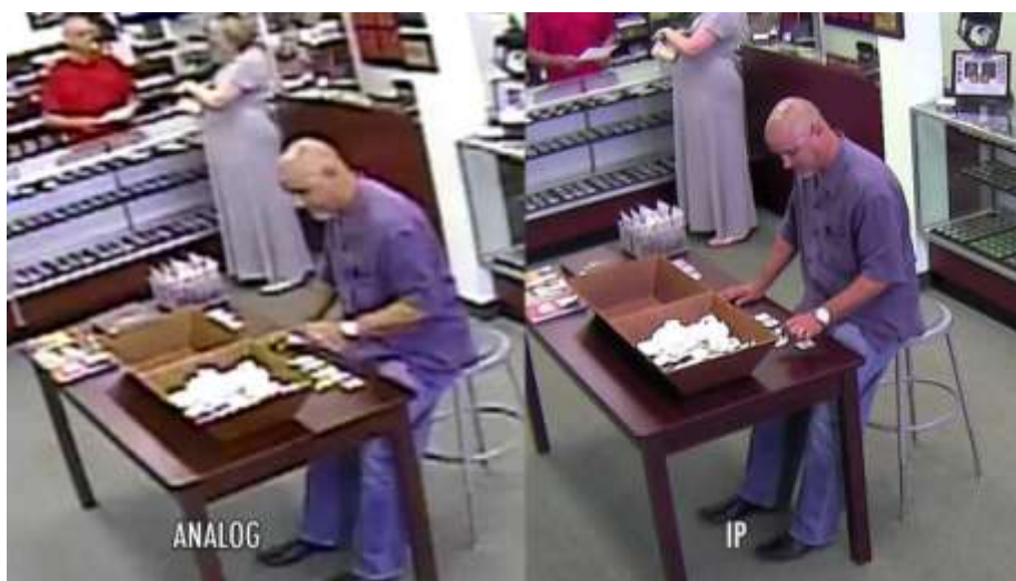
Obr.6 Porovnanie kvality obrazu u analógových kamier a IP kamier [8].
